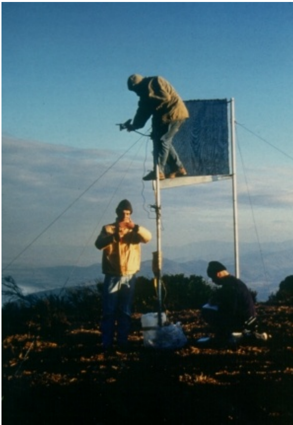
Sistema de colectores de humedad ambiente. Chungungo, Chile (2002).
